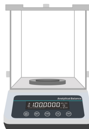
Figura 1 - Representação de uma balança analítica para determinação direta da massa de uma amostra sólida
